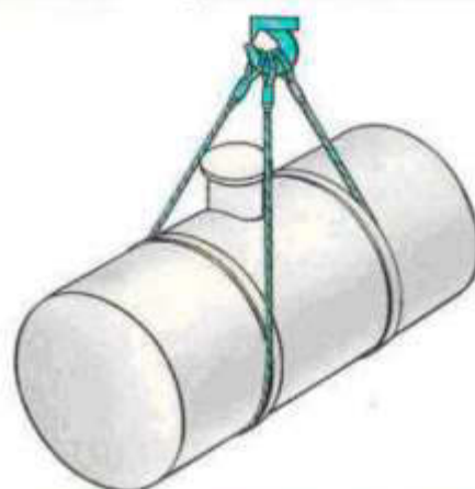
СТРОПОВКА ЦИЛИНДРИЧЕСКОГО РЕЗЕРВУАРА ДВУМЯ ДВУХПЕТЛЕВЫМИ СТРОПАМИ
