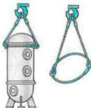
СТРОПОВКА СОСУДА ДВУМЯ ДВУХПЕТЛЕВЫМИ СТРОПАМИ
