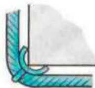
Разрезанные трубы с приварными бобышками
