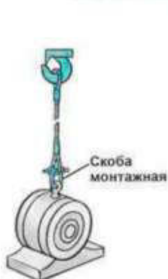
СТРОПОВКА ЭЛЕКТРОДВИГАТЕЛЯ ДВУХПЕТЛЕВЫМ СТРОПОМ
