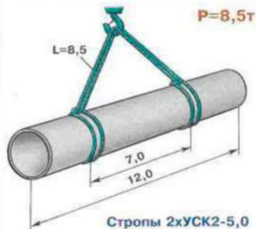
4. Железобетонная оболочка диаметром 0,6 м
