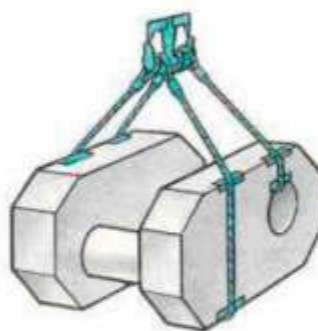
СТРОПОВКА ДЕТАЛИ СТАНКА ДВУМЯ ДВУХПЕТЛЕВЫМИ СТРОПАМИ
